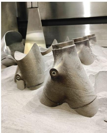
3 pièces ont été réalisées grâce à l'impression 3D. L'idéal pour utiliser un acier maraging de très haute qualité, réputé dans l'aéronautique pour sa résistance.
